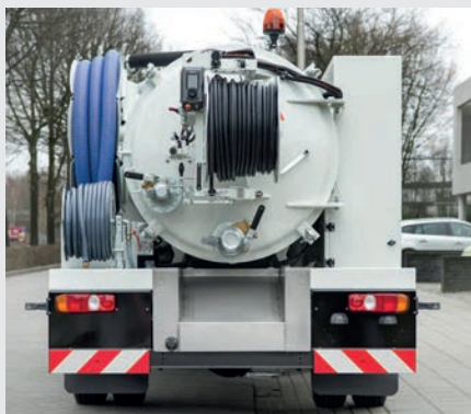
Heckansicht mit Saughaspel, Hochdruck- und Wasserzufuhrhaspel
