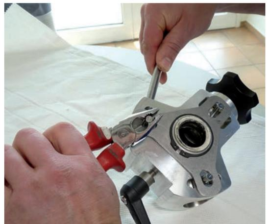
Mittels einer Sprengringzange können Sie nun den Sprengring entfernen. Vorschublagerhalter und Drucklager sind nun frei.
