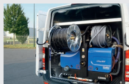
Hydraulische, um 180° schwenkbare Hochdruck-Haspel
