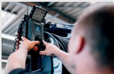
eControlPlus-Steuerung mit elektronischem Meterzähler
