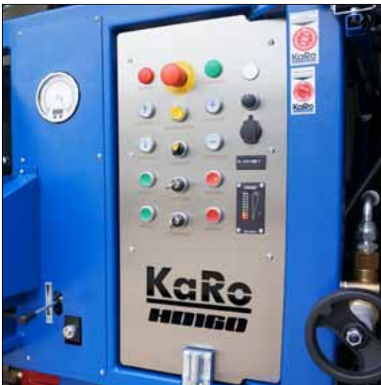
Schaltelemente auf geschliffener Edelstahlplatte
