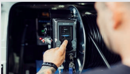
Hydraulische HD-Haspel mit eControl Steuerung (optional)
