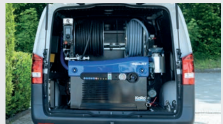
Aggregat passend zum Einbau in viele Kleintransporter
