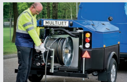
Hydraulische, 180° ausschwenkbare HD-Haspel
