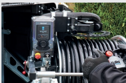
eControlPlus Steuerung an schwenkbarer Haspel
